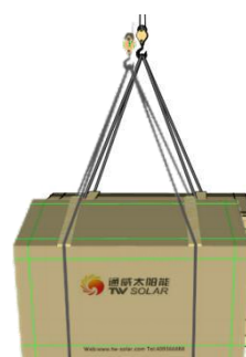
図 6：モジュール吊り上げの模式図
