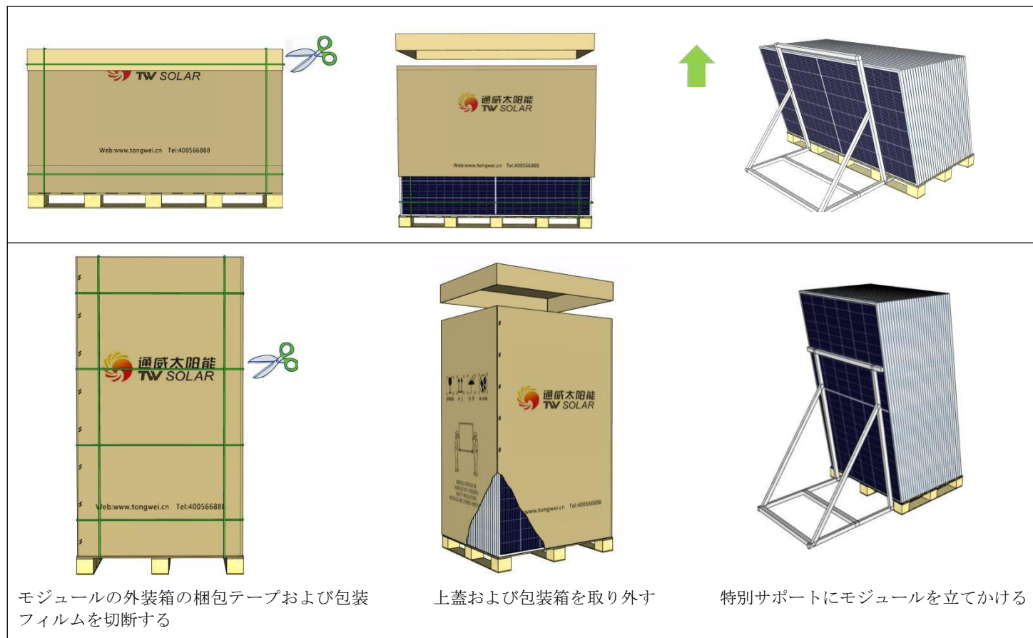
図 13：モジュールの開梱手順の模式図
